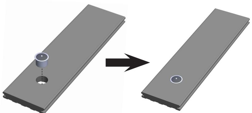
**ACHTUNG:** Da sie stärker ist als die Dielen, kann die Einbauleuchte nicht über einer Unterkonstruktion eingesetzt werden.
