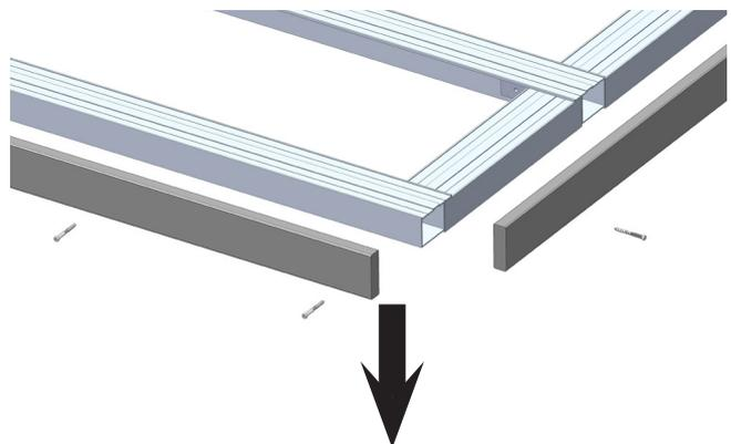
SCHRITT 2: Bohren Sie das Profil mit einem Bohrer von 3,5 mm vor und schrauben Sie dann alle 40 cm eine Schraube direkt ein.
